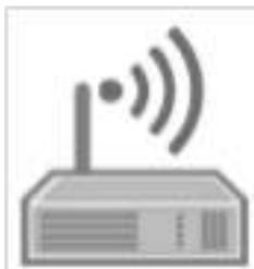
**Le routeur Wifi** permet tout comme le switch de relier plusieurs équipements mais avec une connexion sans fil en Wifi. Pour cela, il génère un sous-réseau local qui lui est propre (d'où le mot routeur)
